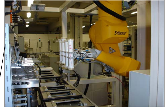
Roboter für zu verschweißende Filter
