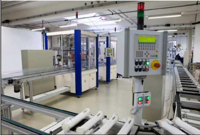
Leckprüf- und Wiegestationen
