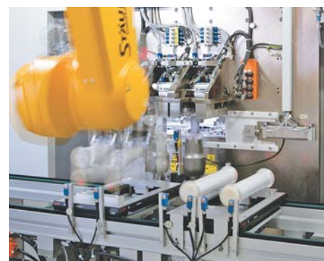
Handhabungsroboter beim Entnehmen der fertigen Filter.
