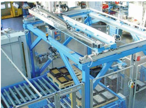
Nach der erfolgreichen Endkontrolle: der Portalpalettierer kurz vor der Auslieferung zum Kunden.
