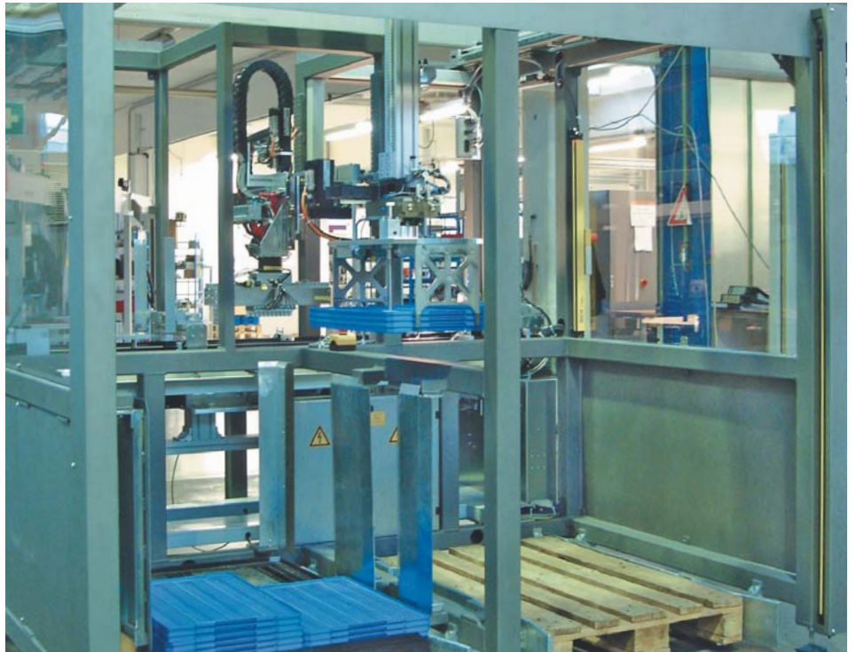
EURO-Line mit Abstapeleinheit für bis zu zehn Trays.
