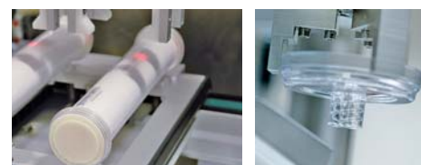
Handhabungsroboter beim Entnehmen der fertigen Filter.
