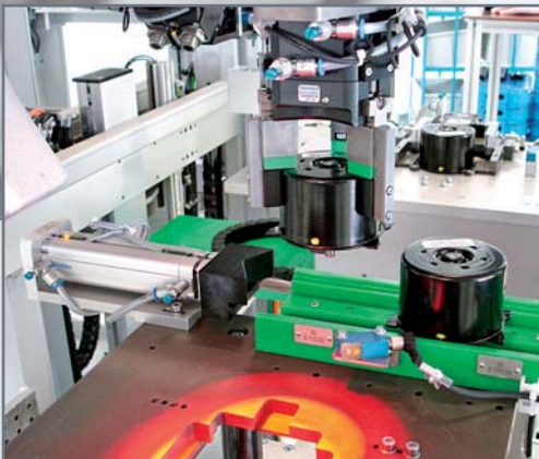
Handlingeinheit mit Greifsystem in einer Montagezelle für ABS-Komponenten.
