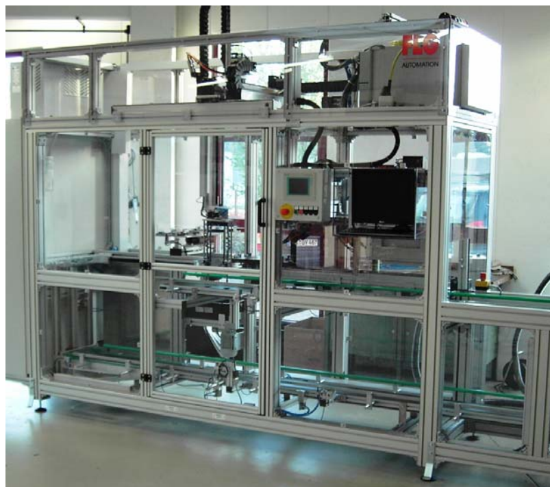
Prüf- und Packstation für Solar Anschlussdosen
