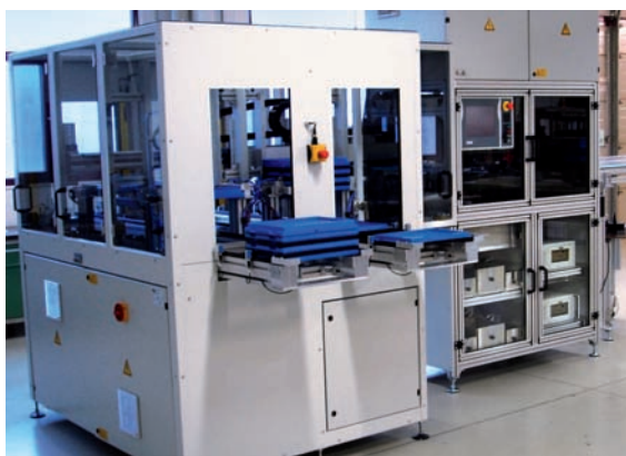
Palettiersystem DUO-Line mit vorgeschalteter Vision-Zelle.
