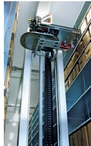
Regalbediengerät bei der Einlagerung von Packstücken.
