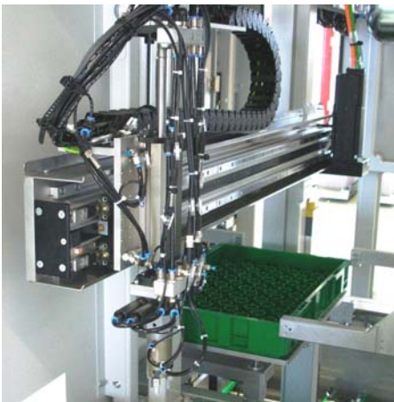
NC-200 als Handlingachse in einem Palettiersystem
